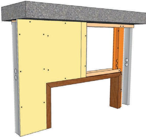
Para resolver el dintel pasante, debemos proceder desde los montantes de modulación más próximos al hueco por cada lado de este. Colocaremos un **refuerzo de canal** por ambos lados desde el montante jamba hasta los montantes de modulación próximos.
