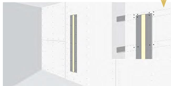
Para atornillar el elemento Gypsomete mediante tornillos autopercutorantes sobre una distancia entre 3/4 cm se aconseja. En caso de doble placa antes de la aplicación del elemento Gypsomete una pieza se atornillará a fin de crear el grosor necesario.
