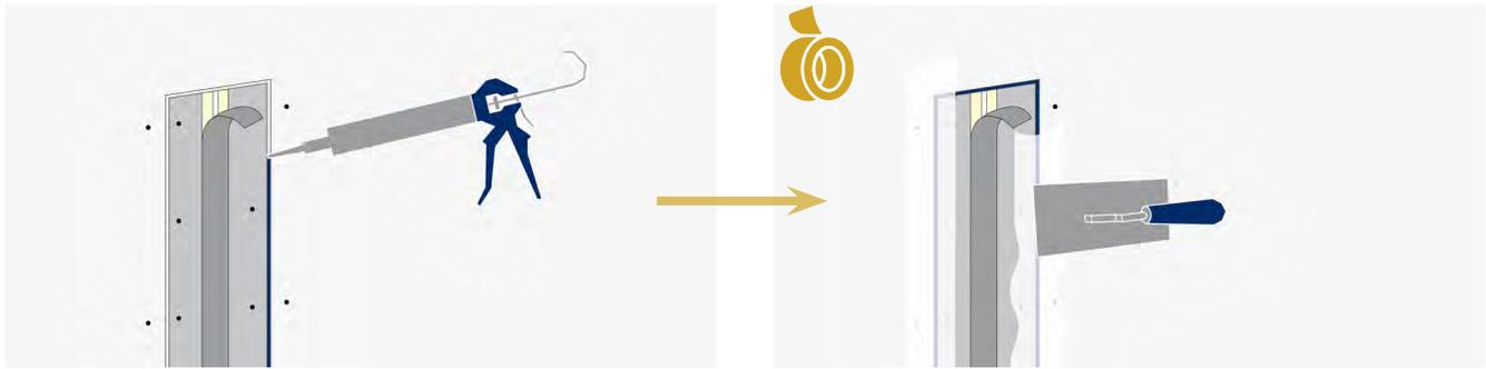
En cuando el elemento Gypsomete es atornillado, uno seguirá con la primera fase del tratamiento de la unión mediante la aplicación del adhesivo sellador de una silicona acrílica. Realizar el rellenado que tiene de aproximadamente 1 mm en el reborde de la placa, en el modo de favorecer en la fase siguiente, la aplicación de las pastas.
