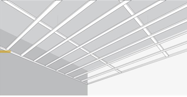
Seguir con la aplicación normal de la estructura metálica y con la colocación de las placas. En la única superficie realizada del falso techo para marcar la forma del elemento Gypsomete. Posteriormente seguirá el mismo procedimiento que la aplicación “el falso techo existente”.
